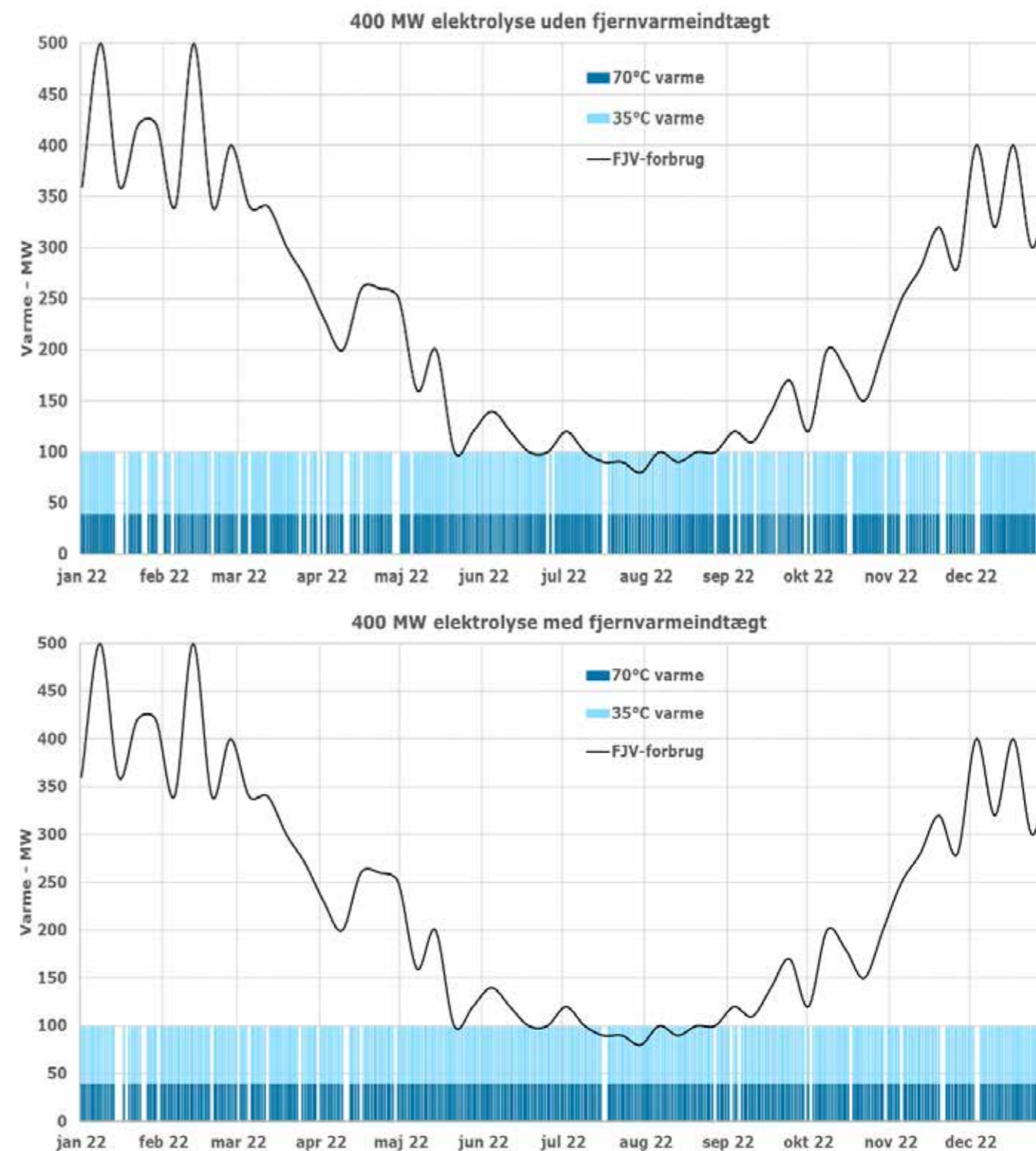
Figur 7. Fjernvarmeproduktion i stort system med overskudsvarme fra elektrolyse. Øverst: Driftsprofil uden fjernvarmeindtægt. Nederst: Driftsprofil med fjernvarmeindtægt. De ekstra driftstimer pga. fjernvarmen ses som færre hvide huller i den nederste profil.
