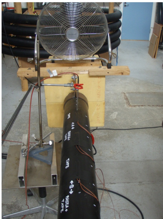
Billede 1: Blæser til aksial luftstrøm omkring overfladefølere
