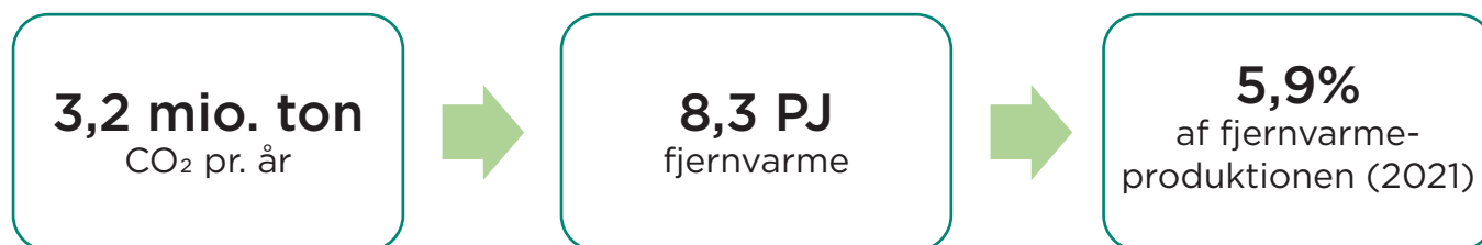
Figur 16: CO 2 -fangst medfører store mængder overskudsvarme
